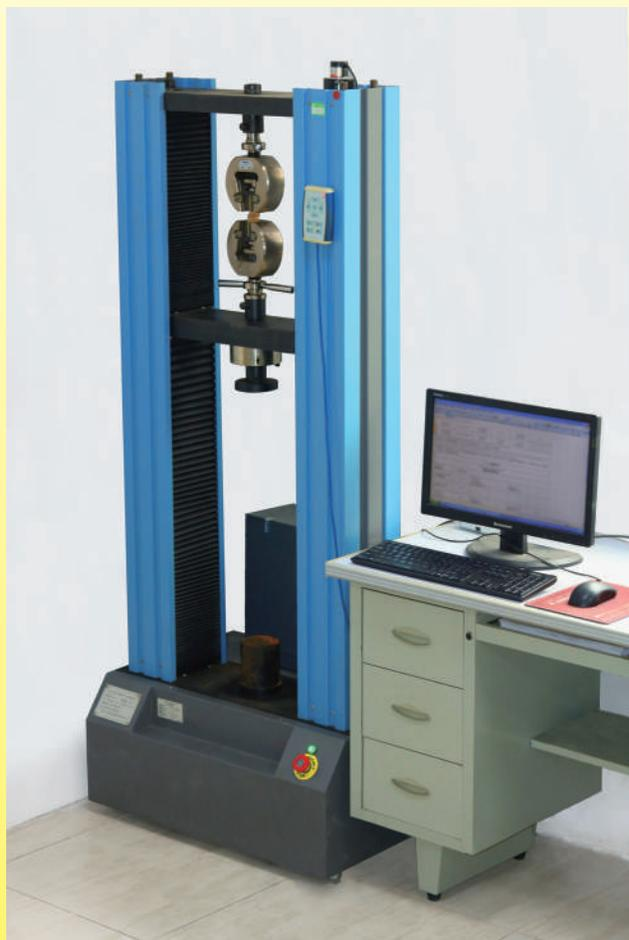
Resistenza alla trazione e allungamento a rottura
